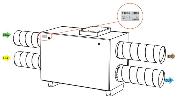
Abbildung 2.3. Platzierung Technischer Aufkleber und Luftkanalanschluss (right version)
