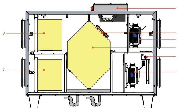
1 - Plattenwärmetauscher; 2 - Zuluftventilator; 3 - Abluftventilator; 4 - Bypassklappe; 5 - Elektroheizregister; 6 - Steuerungsplatine; 7 - Abluftfilter (pocket); 8 - Zuluftfilter (pocket).
