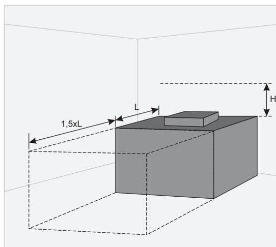
Min. Abstand für Türöffnung -  $1,5xL$ ; Min. Abstand für Öffnung des Schaltkastens -  $H > 400\text{ mm}$ .
