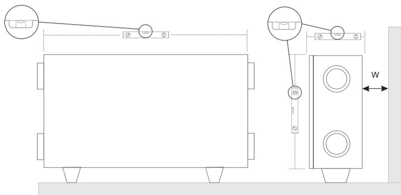
Montageposition: Horizontal Boden ( $W=400\text{mm}$ )
