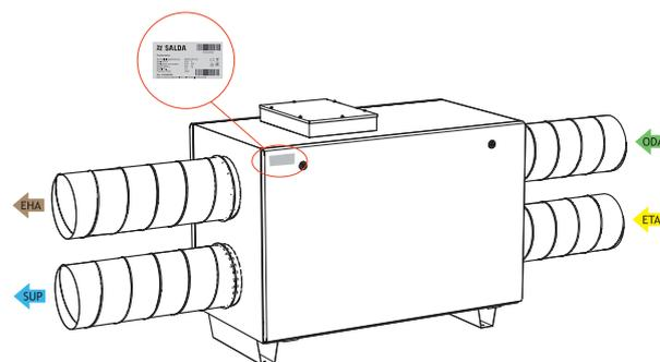
Abbildung 2.4. Platzierung Technischer Aufkleber und Luftkanalanschluss (left version)
